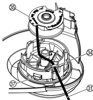
Si le fil de coupe est rentré dans la bobine ou si l'avance automatique du fil ne fonctionne toujours pas après l'extraction du fil de la bobine, il se peut que le fil ③① soit soudé dans la bobine ③⑤.
