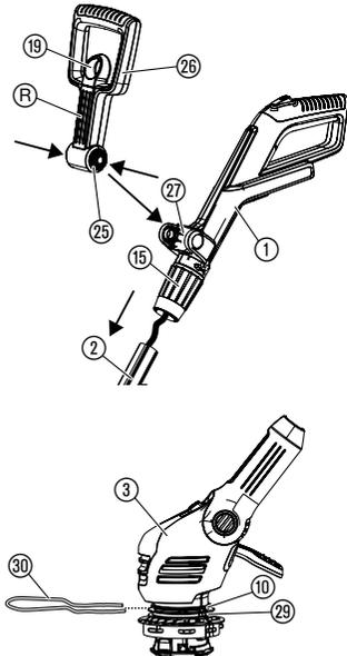
1. Déballez avec précaution la poignée ① et le guidon ②, en veillant à ne pas exercer de tension sur le câble.
