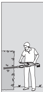
Taglio laterale: Tubo telescopico rientrato
