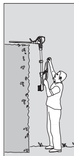
Corte em altura na horizontal: Unidade do motor inclinada em 75°, tubo telescópico estendido
