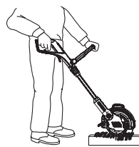
3. munkavégzési helyzet: Ráhajló szegélyek függőleges nyírása
