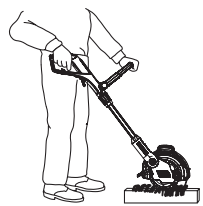
Pozycja robocza 3: Pionowe podkaszanie zwisających krawędzi trawnika
