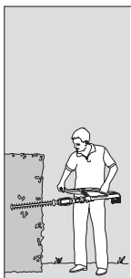
Stransko rezanje: Teleskopska cev pomaknjena noter
