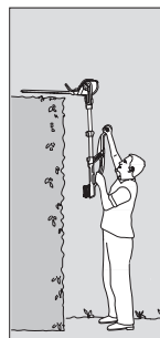
Višinsko horizontalno rezanje: Enota motorja nagnjena za 75°, teleskopska cev je podaljšana
