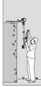
Yüksek yatay kesim: Motor ünitesini 75° eğimli, teleskop boru uzatılmış
