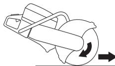
Ne pas déplacer la machine quand l'équipement de coupe tourne. Les forces gyroscopiques peuvent entraver le mouvement prévu.
