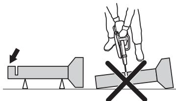
Si la tubería se hunde y se obstaculiza el corte, el disco se atascará en la zona de riesgo de sacudidas y podría producirse una sacudida muy violenta. Si la tubería está sujeta correctamente, el extremo de la tubería se moverá hacia abajo, se abrirá la zona cortada y no se producirá ningún atasco.
