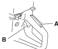
El bloqueador permanece presionado mientras está presionado el acelerador. Al soltar el mango tanto el acelerador como el bloqueo vuelven a su posición original. Esto ocurre gracias a dos sistemas de muelle de retorno independientes entre sí. El acelerador queda, de esta manera, automáticamente bloqueado en ralentí.
