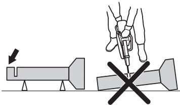
Si le tuyau peut pendre et fermer la coupe, la lame risque d'être pincée dans la zone de rebond et cela peut susciter un rebond important. Si le tuyau est correctement soutenu, l'extrémité du tuyau va descendre et la coupe va s'ouvrir sans aucun pincement.
