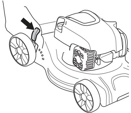
Das Modell LC 146SP verfügt über 3 Bedienelemente. Die gleiche Höhe für alle drei Kontrollpunkte festlegen.
