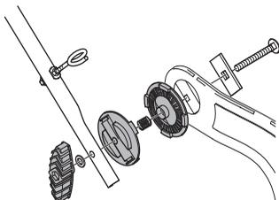
Χρησιμοποιήστε τους περιεχόμενους ιμάντες για να στερεώσετε τις ντίξες στη λαβή. Μην τεντώνετε υπερβολικά τις ντίξες κατά την τοποθέτηση.
