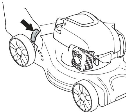
LC 146SP je opremljen s 3 ročicami za nastavitve višine. Na vseh treh kontrolnih točkah nastavite enako višino.
