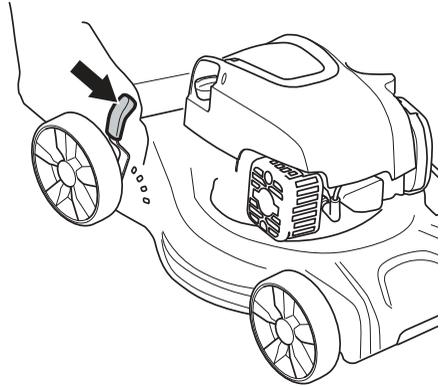
El modelo LC 146SP tiene 3 controles. Ajuste la misma altura en los tres puntos de control.
