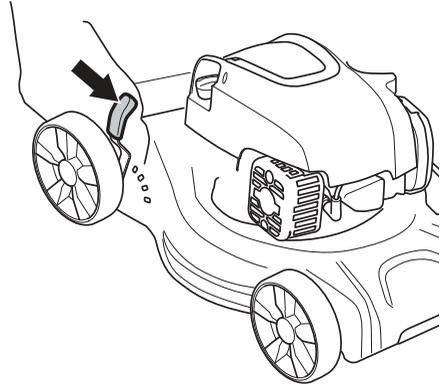
O LC 146SP tem 3 comandos, um para cada roda. Ajuste a mesma altura nos três pontos de controle.
