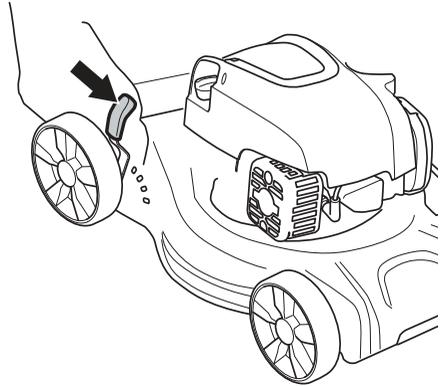
Model LC 146SP má 3 ovládací prvky. Nastavte stejnou výšku sečení ve všech třech kontrolních bodech.
