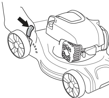
Model LC 146SP wyposażony jest w 3 moduły sterujące każdym kołem osobno. Ustaw tę samą wysokość we wszystkich trzech punktach ustawień.
