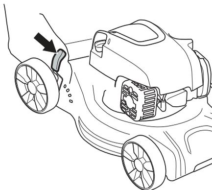
LC 146SP имеет 3 регулятора. Установите одинаковую высоту на всех трех контрольных точках.
