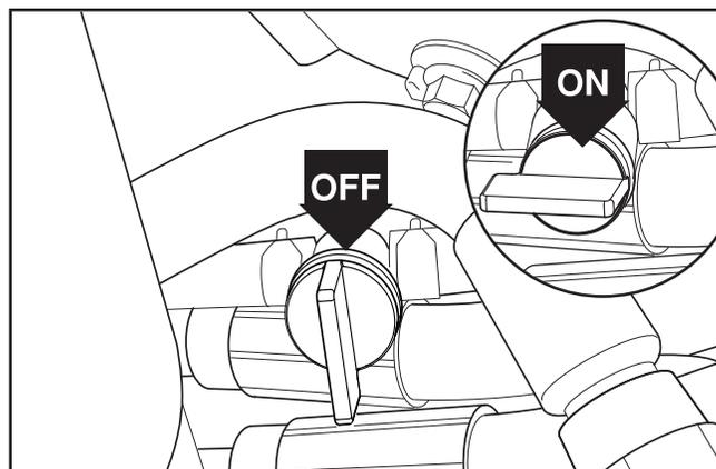
Le robinet de carburant se trouve du côté arrière gauche du siège. La valve est fermée lorsque la languette est tournée perpendiculairement à la conduite d'alimentation en carburant.
