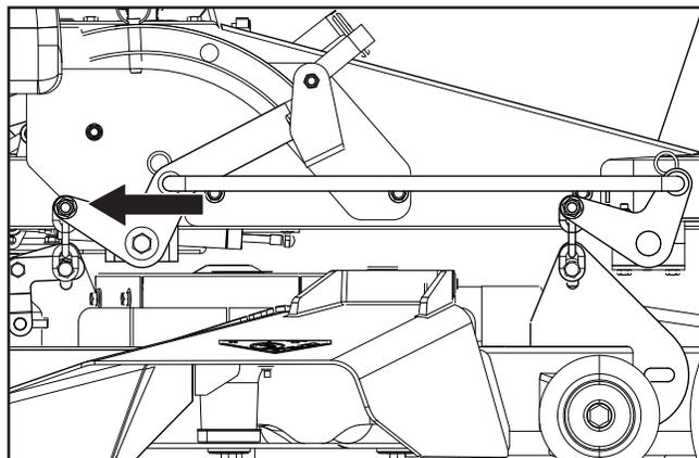
4. Confirmer les mesures une fois de plus. Il convient de mettre à niveau les extrémités de la lame de façon côte à côte. À l'arrière, il convient de mettre à niveau les extrémités de la lame 0,32 cm (1/8") plus haut que la mesure côte à côte. À l'avant, il convient de mettre à niveau les extrémités de la lame 0,32 cm (1/8") plus bas que la mesure côte à côte.
