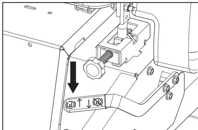
**INFORMATION IMPORTANTE** La machine doit être complètement immobile au moment de serrer le frein de stationnement. Toujours serrer le frein de stationnement avant de descendre de la tondeuse. Desserrer le frein de stationnement avant de faire avancer la tondeuse.
