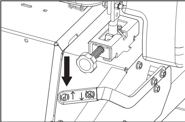
2. Déplacer les commandes de direction vers l'intérieur à la position point mort (N).
