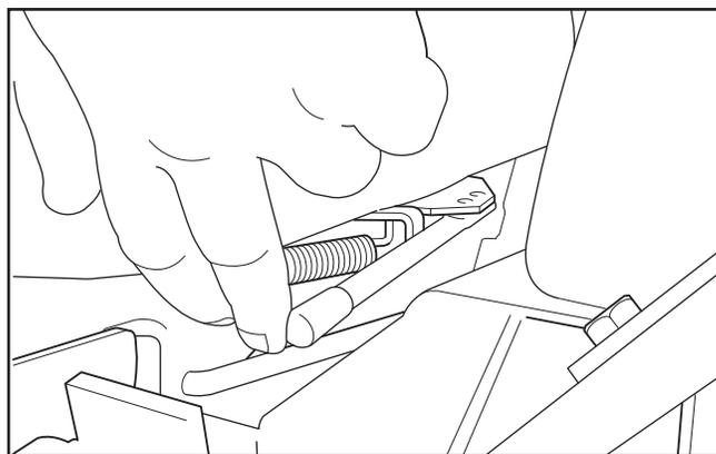
5. Sélectionner la hauteur de coupe en plaçant la goupille de hauteur de coupe dans le trou correspondant.
