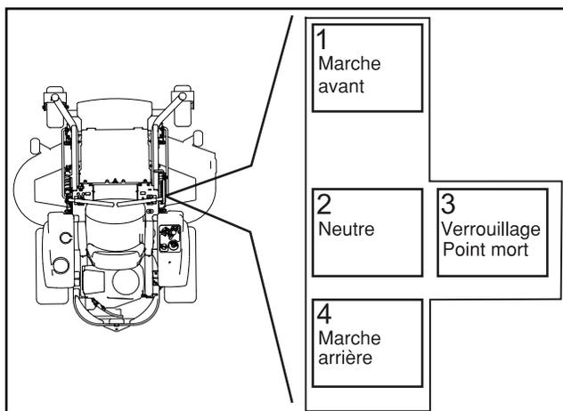
**AVERTISSEMENT!** La machine peut tourner assez rapidement si l'une des commandes de direction est déplacée plus vers l'avant par rapport à l'autre.
