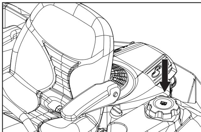
Lire les consignes de sécurité avant d'effectuer un plein de carburant. La machine comporte un réservoir de carburant se trouvant derrière la console. Le volume du réservoir est de 13,25 litres (3,5 gallons).
