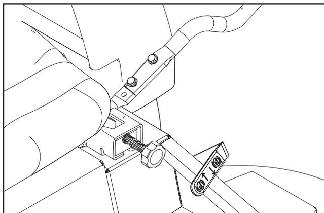
6. Déplacez la manette des gaz sur la position médiane. Si le moteur est froid, il faut tirer sur la commande de l'étrangleur.
