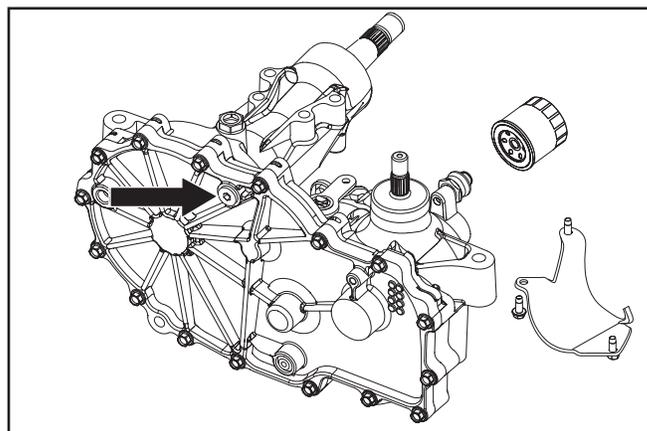
2. Placez un bac de récupération d'huile (idéalement d'un diamètre de 31 cm ou plus et d'une capacité de 9 litres) sous le filtre à huile. Retirez le filtre à huile de l'axe transversal.
