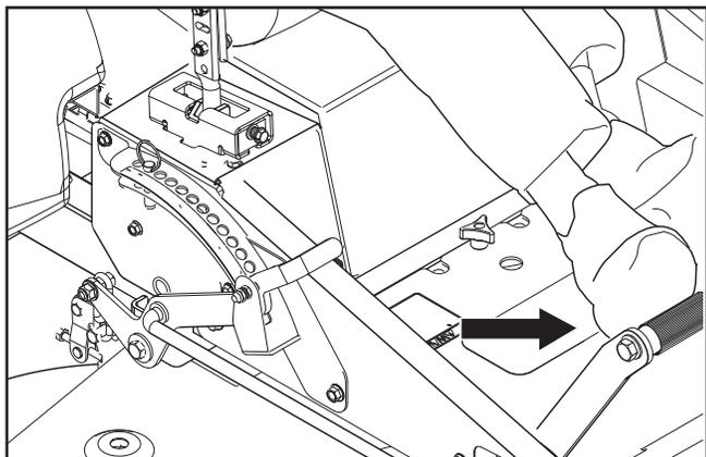
5. Lorsque la machine est immobile, serrer le frein de stationnement en poussant sur le bouton de dégagement du levier et en tirant le levier vers le haut. Si le moteur a été utilisé longtemps, il faut le laisser tourner au ralenti environ 60 secondes avant d'atteindre une température de fonctionnement normal avant de l'éteindre. Pour éviter de noyer les bougies d'allumage, ne pas laisser le moteur tourner au ralenti trop longtemps.
