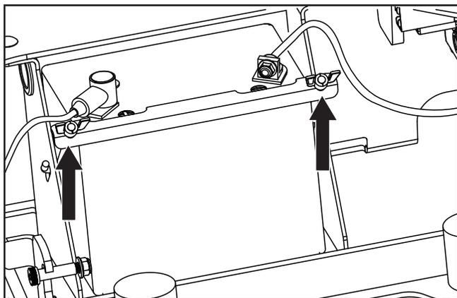
3. Utiliser deux clés 1/2 po pour débrancher le câble de batterie NOIR, puis le câble de batterie ROUGE.
