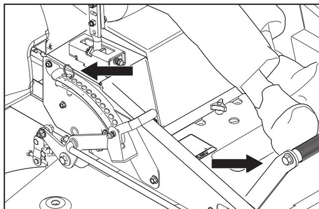
La goupille de hauteur permet de régler la hauteur de coupe souhaitée. La pédale de hauteur de coupe relâche le levage de l'unité et place l'unité à la hauteur sélectionnée.
