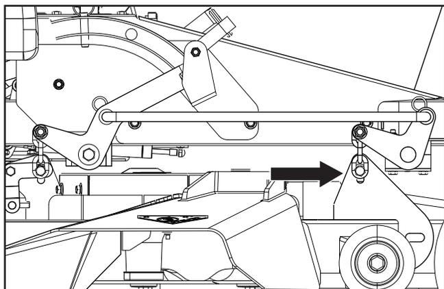
3. Tourner les deux lames extérieures pour les aligner au plateau de façon avant-arrière. Repositionnez les vis de fixation arrière vers le haut ou vers le bas jusqu'à ce que l'arrière de l'unité de coupe soit 0,32 cm (1/8") plus haut à l'arrière par rapport à la mesure côte à côte.
