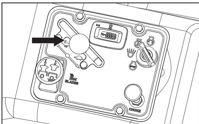
La commande de l'accélération contrôle le régime moteur et, par conséquent, le taux de rotation des lames, en supposant que le levier de commande des lames est tiré.
