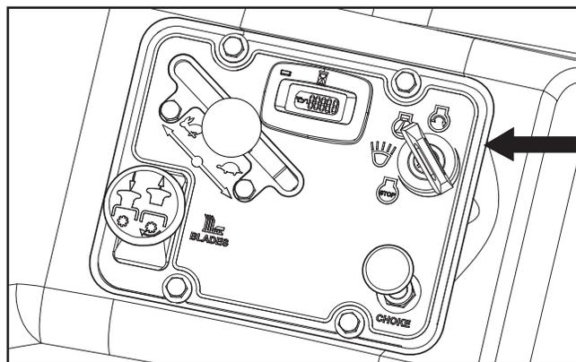
L'interrupteur d'allumage se trouve dans le panneau de commande et il sert pour le démarrage et l'arrêt du moteur. Sur les modèles équipés de phares, tourner la clé dans le sens horaire sur ACCESSORY pour les utiliser.
