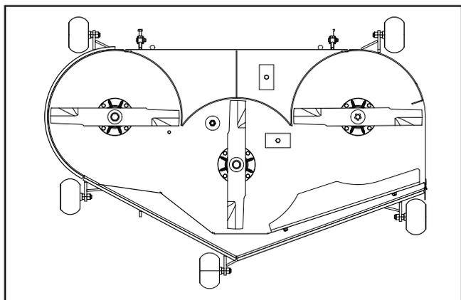
2. À partir du sol, mesurer jusqu'au bas de l'extrémité de la lame sur le côté de décharge de l'unité du plateau de la tondeuse. Retenir cette mesure. Passer de l'autre côté et vérifier si la mesure est identique. S'il est nécessaire de procéder à un réglage, desserrer le contre-écrou puis déplacer la vis de fixation vers le bas ou vers le haut dans la rainure jusqu'à ce que les deux mesures côte à côte soient identiques. Retenir la mesure.
