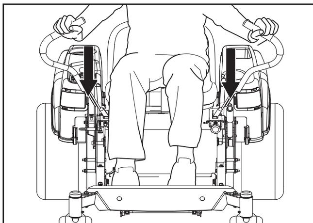
Contrôler tous les jours que le système de sécurité fonctionne correctement en essayant de mettre en marche le moteur quand l'une de ces conditions n'est pas remplie. Passer à une autre condition et essayer de nouveau.
