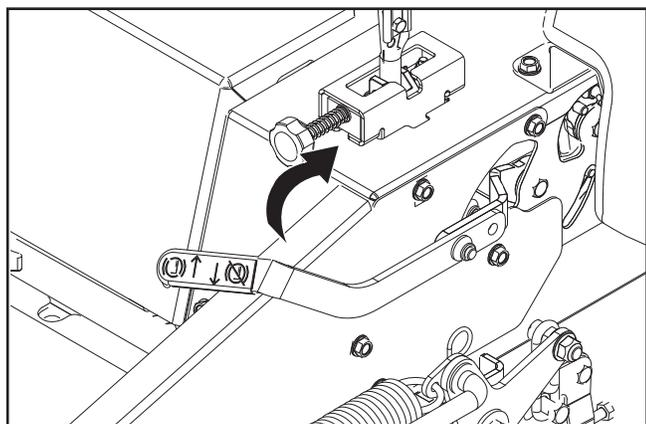
4. Désactiver les lames de la tondeuse en enfonçant le commutateur de lame.
