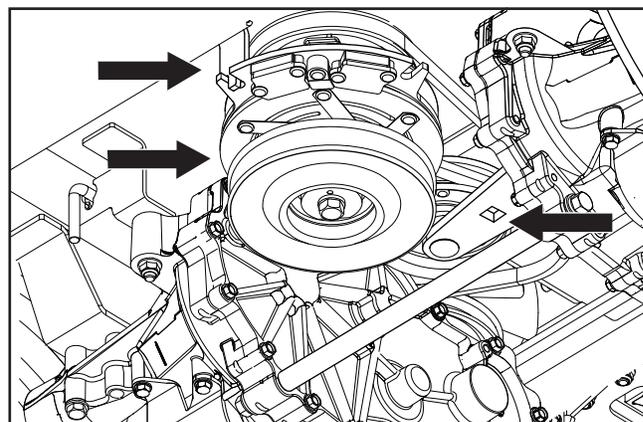
5. Lorsque le bras de renvoi est relâché, glissez un tournevis, un axe de chape ou un outil similaire dans le trou de  $\frac{3}{8}$ " dans la plaque située entre les deux capots de ventilateurs. Cela maintiendra la poulie folle en position étendue et permettra de retirer la douille à poignée articulée.
