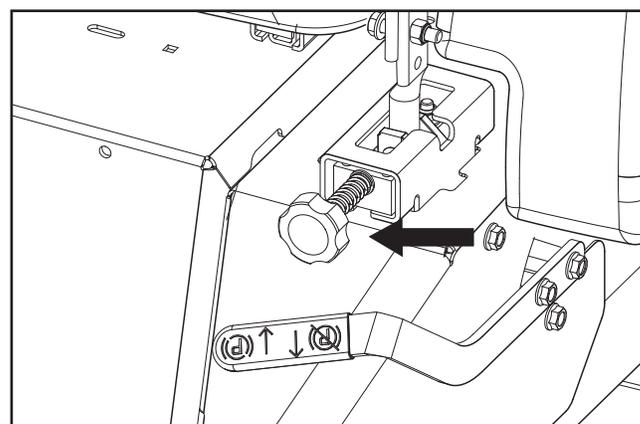
Si la tondeuse ne roule pas en ligne droite, vérifier la pression d'air dans les pneus arrière. La pression recommandée est de 103 kPa / 1 bar (15 lb/po2) dans tous les pneus. L'alignement doit être vérifié sur une surface plane et de niveau (ciment ou bitume).
