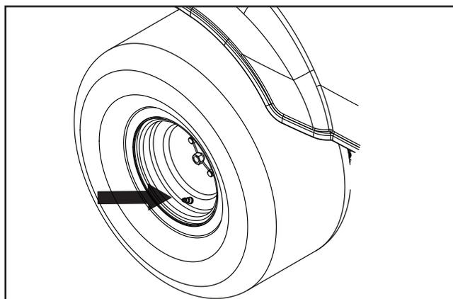
**INFORMATION IMPORTANTE** NE PAS ajouter de revêtement intérieur ou de matériau en mousse dans les pneus. La charge excessive occasionnée par les pneus remplis de mousse aura pour effet d'entraîner une usure prématurée. Utiliser uniquement des pneus indiqués par le FEO.
