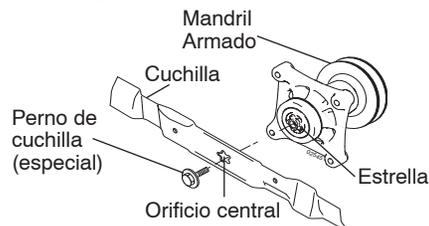
**IMPORTANTE:** Para asegurar un ensamblaje correcto, el orificio central de la cuchilla se debe alinear con la estrella del ensamblaje del mandril.
