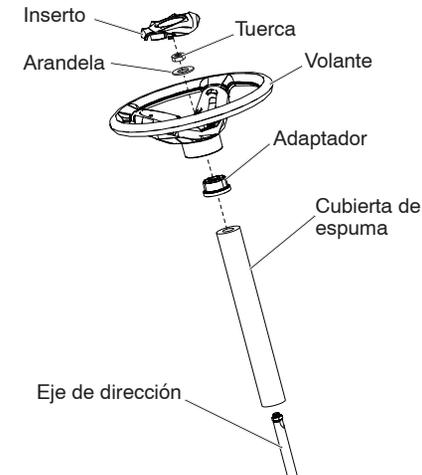
6. Retire el adaptador del volante y deslice el adaptador sobre el eje de dirección.
