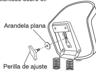
6. Deslice el asiento hasta que logre una posición cómoda, lo que le permitirá presionar el pedal del embrague/freno hasta el fondo.
