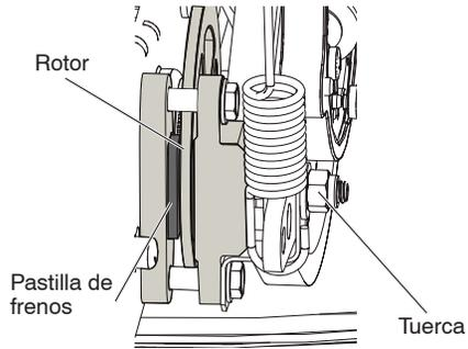
**NOTA:** Puede ser necesario usar un calibrador de hoja para obtener la medida correcta.
