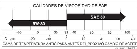
**NOTA:** Auque los aceites de viscosidad múltiple (5W30, 10W30, etc.) mejoran el arranque en climas fríos, los aceites provocarán un incremento en el consumo de aceite cuando se usan por encima de los 0°C/32°F. Revise el nivel de aceite del motor con más frecuencia para evitar cualquier posible daño en el motor debido a un nivel bajo de aceite. Cambie el aceite después de cada 25 horas de operación o al menos una vez al año si no se va a usar la cortadora de césped durante 25 horas en un año.
