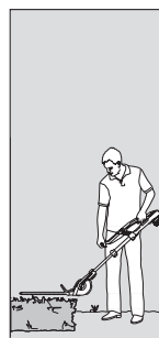
Niedriges Schneiden: Motoreinheit um –60° geneigt, Teleskoprohr verlängert
