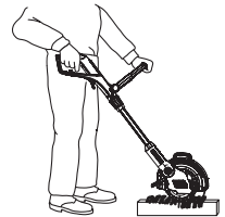
Arbeitsposition 3: Senkrecht Trimmen überhängender Rasenkanten
