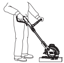
Werkpositie 3: Vertikaal trimmen van overhangende graskanten
