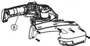
1. Li-Ion-Zellen ⑧ vollständig entladen.
