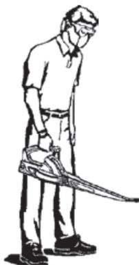
Utilisez votre appareil en mode souffleur pour repousser les débris et les déchets de coupe des chaussées, allées, patios, etc. et rassembler en tas les déchets de coupe, la paille ou les feuilles, ou encore pour éliminer les débris des coins, autour des jointures ou entre les briques.
