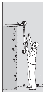
Taglio orizzontale elevato: Unità motore inclinata di 75°, tubo telescopico prolungato
