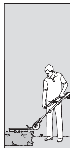
Corte baixo: Unidade do motor inclinada em -60°, tubo telescópico estendido
