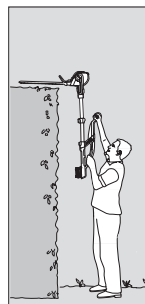
Висока хоризонтална стрижка: Секцията на електродвигателя е под наклон от 75°, телескопичната тръба е изтеглена
