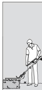
Ниска стрижка: Секцията на електродвигателя е под наклон от – 60°, телескопичната тръба е изтеглена
