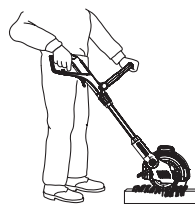
Pracovní poloha 3: Svislé trimování přečnickujících hran trávníku
