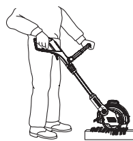
Pracovná poloha 3: Zvislé vyžínanie previsnutých trávnikových hrán
