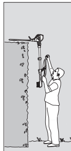
Høj vandret klipping: Motorenheden vippet 75°, teleskoprøret er forlænget
