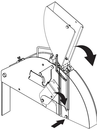
**ATTENTION !** N'utilisez pas cette scie sans que le loquet soit engagé et le boulon installé. N'utilisez pas la scie si elle est endommagée.
