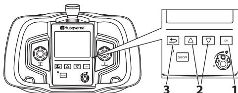
Le système de menus de la télécommande est accessible via le bouton « OK ». Le système de menus comprend les sous-menus suivants :
