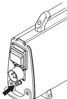
L'autre point d'alimentation en eau doit être relié à l'outil électrique, lequel dispose de plusieurs robinets permettant de réguler le débit d'eau de refroidissement au niveau de l'outil. Consulter le manuel de l'opérateur correspondant aux outils électriques utilisés.
