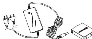
Le temps de chargement d'une batterie à plat est d'environ 2-3 heures. La diode est orange lorsque le chargement démarre et devient verte lorsque la batterie est pleine. Lorsque la batterie est pleine, le chargeur envoie à la batterie un courant de service jusqu'à ce qu'il soit débranché.
