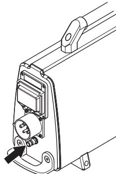
La otra conexión debe conectarse a la herramienta eléctrica, que dispone de varias llaves de paso para regular el caudal de agua que recibe. Consulte el manual de usuario de la herramienta eléctrica correspondiente.
