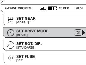
Il est aussi possible de sélectionner le mode d'entraînement à partir de l'écran d'accueil à l'aide des flèches de direction.
