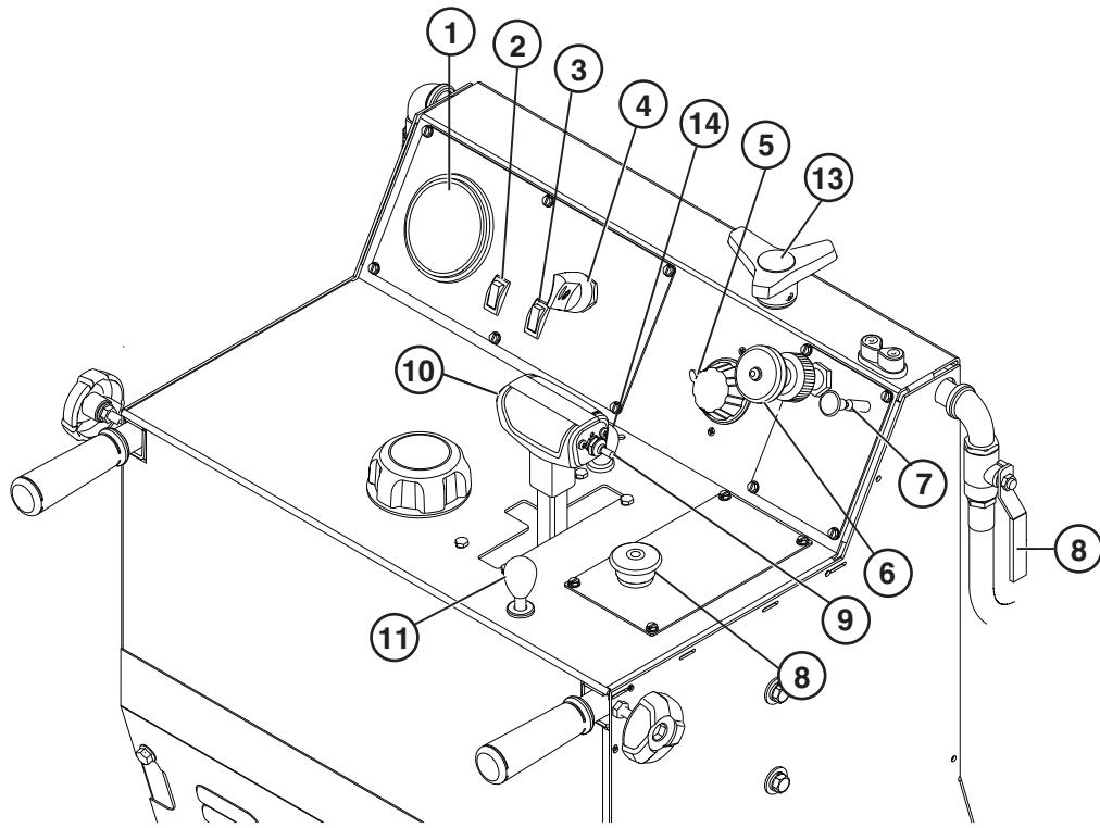
Le panneau de commande est l'élément qui relie l'opérateur à la machine. À partir de ce panneau, l'opérateur peut contrôler la vitesse de rotation du moteur en tours par minute, commander la profondeur de coupe de la lame et afficher l'état actuel du moteur et de la machine.
