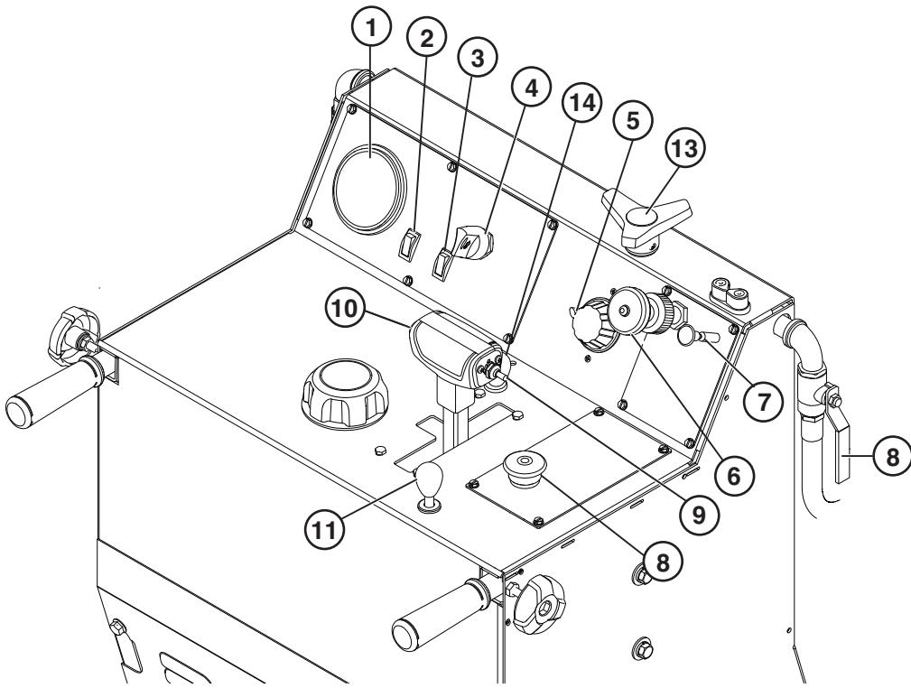
El panel de control es el enlace del operador con la máquina. Desde aquí, el operador puede controlar cualquier cosa, desde las rpm del motor, la profundidad de corte del disco y leer el estado actual del motor y la máquina..
