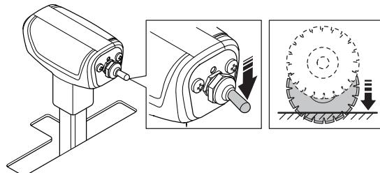
**REMARQUE !** Lors de l'abaissement de la lame dans une coupe partielle, alignez exactement la lame avec la coupe pour éviter d'endommager la lame.
