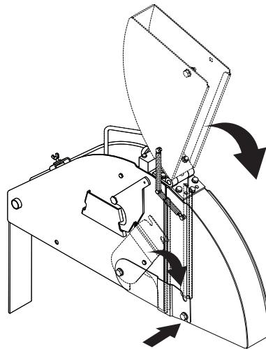
**ATTENTION !** N'utilisez pas cette scie sans que le loquet soit engagé et le boulon installé. N'utilisez pas la scie si elle est endommagée.
