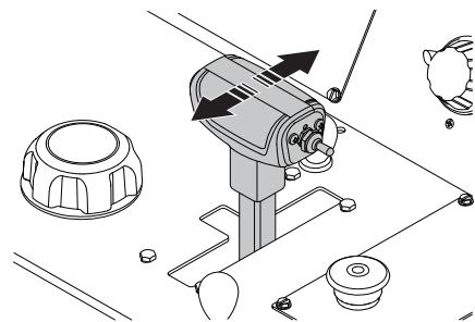
**¡ATENCIÓN!** No coloque la transmisión en posición neutra mientras la máquina está aparcada en una pendiente pronunciada. El operario perderá el control y podrían producirse daños o lesiones.
