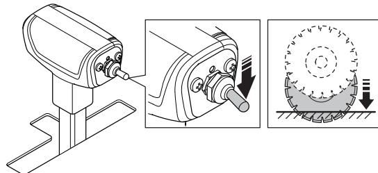
**¡NOTA!** Cuando baje el disco en un corte parcial, alinee el disco exactamente con el corte para evitar daños en el disco.
