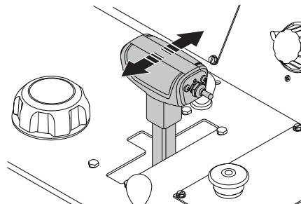
**AVERTISSEMENT!** Ne placez pas la transmission au point mort lorsque la scie est stationnée sur une pente ou une colline. L'opérateur perdra la maîtrise de la machine et pourrait subir des blessures ou provoquer des dommages.
