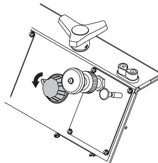
**REMARQUE !** Pour éviter d'endommager la lame, cette dernière doit toucher doucement la surface. Utilisez le bouton de commande de vitesse d'abaissement pour ralentir la vitesse d'abaissement.
