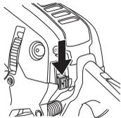
**REMARQUE!** Le bouton marche/arrêt retourne automatiquement en mode de conduite. Afin d'éviter tout démarrage accidentel, toujours retirer le capuchon de la bougie lors du montage, contrôle et/ou entretien.
