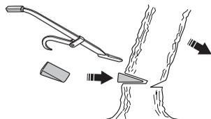
Nous recommandons une longueur de guide-chaîne supérieure au diamètre du tronc, pour que le trait de chute et l'encoche soient réalisés d'un simple trait de scie. Vous trouverez des informations sur les longueurs de guide-chaîne recommandées pour votre modèle de tronçonneuse au chapitre Caractéristiques techniques.
