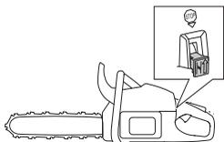
REMARQUE! Le bouton marche/arrêt retourne automatiquement en mode de conduite. Afin d'éviter tout démarrage accidentel, toujours retirer le capuchon de la bougie quand la machine n'est pas sous surveillance.
