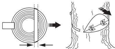
Le contrôle de la direction de chute de l'arbre fonctionne mal si la charnière est trop petite ou coupée trop profondément ou si les deux entailles ne coïncident pas.
