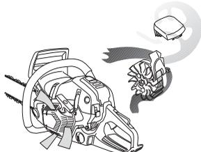
**IMPORTANT!** L'épuration centrifuge exige un entretien correct et continu de la machine. Nettoyer la prise d'air du lanceur, les ailettes du ventilateur, le compartiment du volant, le tuyau d'admission et le compartiment du carburateur.
