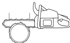
Il existe des méthodes d'abattage spécifiques pour les troncs dont le diamètre est supérieur à la longueur du guide-chaîne. Ces méthodes comportent un risque important de choc entre la zone de rebond du guide-chaîne et un objet.
