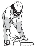
**REMARQUE!** Ne pas sortir complètement la corde du lanceur et ne pas lâcher la poignée avec la corde du lanceur complètement sortie. Cela pourrait endommager la machine.
