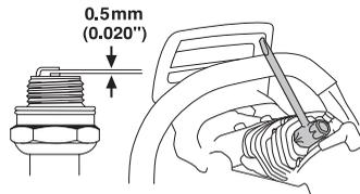
Remarque! Toujours utiliser le type de bougie recommandé! Une bougie incorrecte peut endommager le piston/le cylindre. S'assurer que la bougie est dotée d'un antiparasites.
