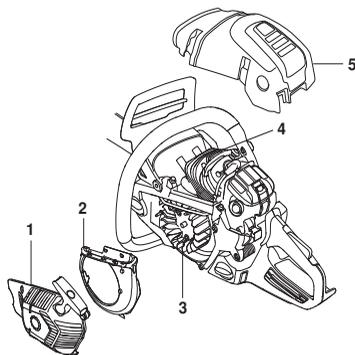
Nettoyer le système de refroidissement avec une brosse une fois par semaine, voire plus souvent dans des conditions difficiles. Un système de refroidissement sale ou colmaté provoque la surchauffe de la machine, endommageant le cylindre et le piston.
