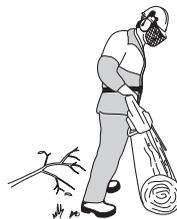
Ne se déplacer qu'avec le tronc entre soi et la tronçonneuse.
