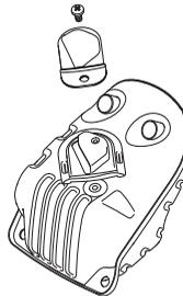
Le silencieux est conçu pour atténuer le bruit et dévier le flux des gaz d'échappement loin de l'utilisateur. Ces gaz sont chauds et peuvent transporter des étincelles risquant de causer un incendie si elles entrent en contact avec un matériau sec et inflammable.
