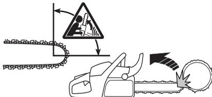
Le rebond se produit toujours dans le plan du guide-chaîne. En général, tronçonneuse et guide-chaîne sont relevés simultanément en direction de l'utilisateur. Néanmoins, la direction du rebond peut varier suivant la
