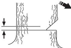
Le trait de chute doit s'achever parallèlement à l'encoche, l'espace entre les deux étant 1/10 du diamètre du tronc. La partie non coupée du tronc s'appelle la charnière.
