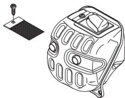
Le silencieux est conçu pour atténuer le bruit et dévier le flux des gaz d'échappement loin de l'utilisateur. Ces gaz sont chauds et peuvent transporter des étincelles risquant de causer un incendie si elles entrent en contact avec un matériau sec et inflammable.
