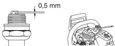
Remarque! Toujours utiliser le type de bougie recommandé! Une bougie incorrecte peut endommager le piston/le cylindre. S'assurer que la bougie est dotée d'un antiparasites.
