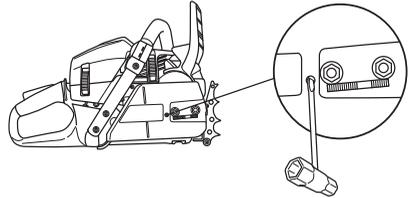
La chaîne est tendue correctement quand elle ne pend plus sous le guide et peut être avancée à la main sans difficulté. Serrer les écrous du guide à l'aide de la clé universelle tout en maintenant levé le pignon du guide.
