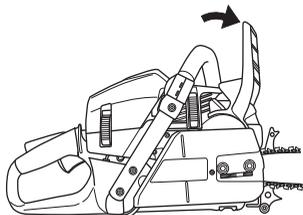
**Allumage; starter:** Mettre la commande de starter sur la position de starter. Le contacteur d'arrêt doit alors se placer automatiquement en position de démarrage.
