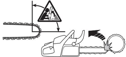
Le tronçonnage avec la partie inférieure de la chaîne, c'est à dire par dessus (de haut en bas), s'appelle méthode "poussée". La tronçonneuse est attirée vers l'arbre et le bord avant de la tronçonneuse devient un appui naturel contre l'arbre. Dans ce cas, l'utilisateur contrôle mieux à la fois sa tronçonneuse et la zone de rebond du nez.
