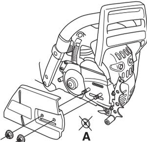
Positionner le guide-chaîne sur les écrous et l'amener à sa position la plus reculée. Placer la chaîne sur le pignon d'entraînement et dans la gorge du guide-chaîne. Commencer par le dessus du guide.
