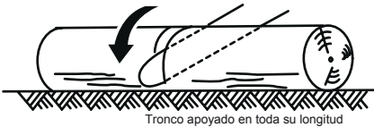
Tronco apoyado en toda su longitud
