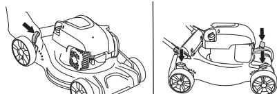
Le modèle M40-125, M46-125 est doté de quatre commandes, une pour chaque roue.
