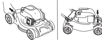
M40-125, M46-125 je opremljen s štirimi ročicami za nastavitev višine; po ena ročica na kolo.
