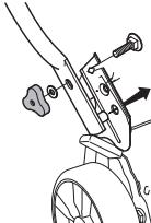
Utilizați curele capsulate pentru a fixa cablurile pe mâner. Nu întindeți excesiv cablurile la montare.
