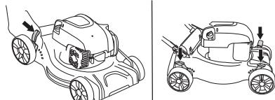
Das Modell M40-125, M46-125 verfügt über vier Bedienelemente, eines für jedes Rad.
