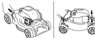
Model M40-125, M46-125 wyposażony jest w cztery moduły sterujące każdym kołem osobno.
