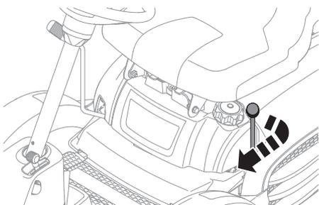
Desplace la palanca hacia atrás y bloquéela para detener la rotación de las cuchillas.
