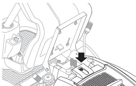
Controllare che la presa per il raffreddamento del motore non sia bloccata da foglie, erba o sporcizia.
