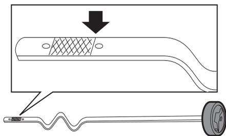
Das Öl wird durch die Öffnung nachgefüllt, in der der Messstab sitzt.
