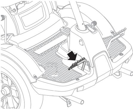
Bremse und Kupplung werden aktiviert, indem das Pedal vollständig heruntergedrückt wird. Das Auskupplungspedal kuppelt den Motor aus und stoppt den Antrieb. Der Antrieb der Messer wird nicht vom Auskupplungspedal beeinflusst.
