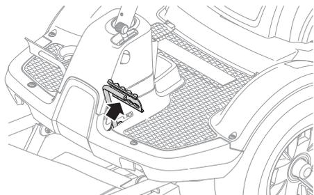
Il pedale può anche essere usato per regolare temporaneamente l'altezza di taglio, per esempio se si passa su un piccolo dosso nel prato.
