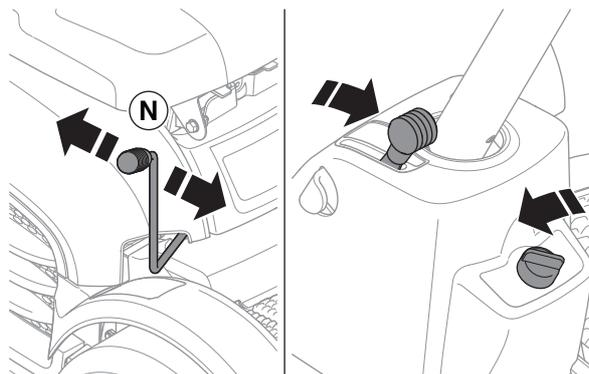
Quando il rasaerba semovente è fermo, inserire il freno di stazionamento.
