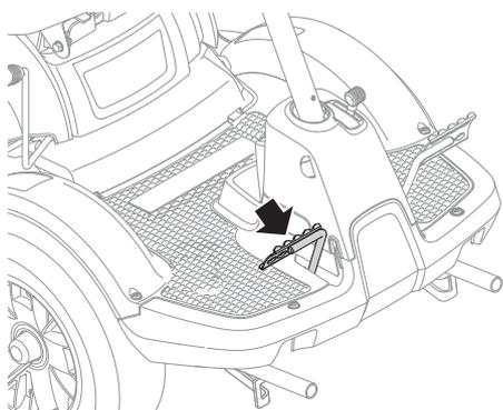
Pise el pedal a fondo para frenar y embragar. El pedal de desacoplamiento desacopla el motor y detiene la propulsión. El pedal de desacoplamiento no afecta a la propulsión de las cuchillas.
