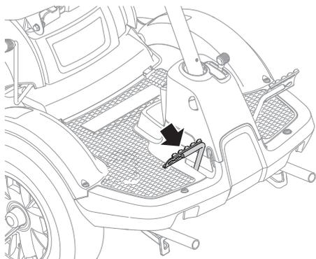
Il suffit d'appuyer à fond sur la pédale pour que l'embrayage et le frein soient engagés. La pédale de débrayage débraye le moteur et arrête l'entraînement. L'entraînement des couteaux n'est pas modifié par la pédale de débrayage.
