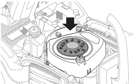
Bei verstopftem Lufteinlassgitter, Luftleitweg oder Kühlluftinlass verschlechtert sich die Kühlung des Motors, was zu Schäden am Motor führen kann.
