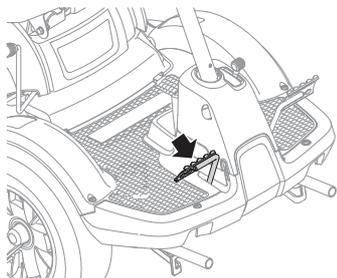
Débrayer le moteur et passer la vitesse souhaitée. Relâcher prudemment la pédale de débrayage.
