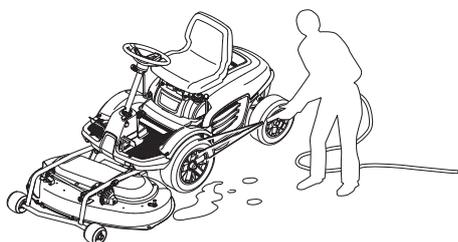
**BELANGRIJK!** Plaats de machine altijd op een vlakke ondergrond met de motor UIT voordat u enig onderhoud pleegt.
