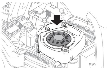
Bij een verstopt luchtinlaatrooster, luchtleiding of koelluchtinlaat verslechtert het koelen van de motor, hetgeen kan leiden tot beschadiging aan de motor.
