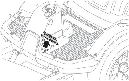
Das Pedal kann auch dazu verwendet werden, die Schnitthöhe vorübergehend anzupassen, wenn zum Beispiel eine kleinere Bodenwelle passiert wird.
