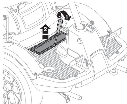
Für das Wiedereinsetzen der Abdeckung muss diese zuerst gebogen, dann an den Seiten eingefügt und schließlich durch Drücken eingepasst werden.
