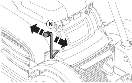
Heben Sie den Hebel an und ziehen Sie ihn nach hinten, um rückwärts zu fahren.
