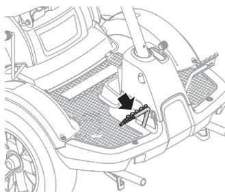
Disinnestare il motore e ingranare la marcia desiderata. Rilasciare delicatamente il pedale di disinnesto.
