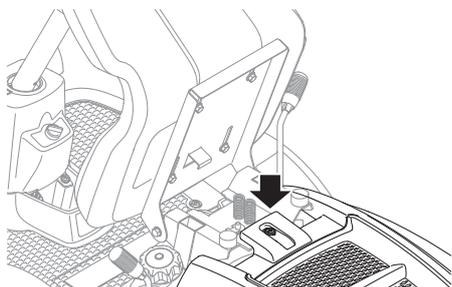
Controleer of de koelluchtinlaat van de motor vrij is van bladeren, gras en vuil.
