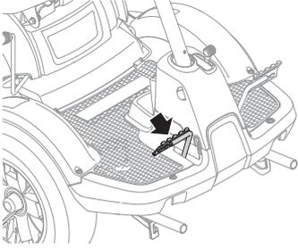
Desacople el motor y engrane la marcha deseada. Suelte con cuidado el pedal de desacoplamiento.
