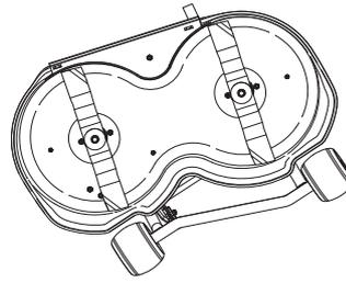
**WICHTIG!** Sind eine oder mehrere Klingen durch eine Beschädigung oder aufgrund schlechter Auswuchtung nach dem Schärfen aus dem Gleichgewicht geraten, kann dies zu Vibrationen in der Maschine führen.
