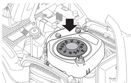
Si la grille de la prise d'air, le conduit d'air ou la prise d'air de refroidissement sont bouchés, le refroidissement du moteur en pâtit, avec les dommages éventuels que cela peut entraîner.
