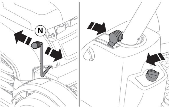
Cuando detenga el cortacésped, accione el freno de estacionamiento.
