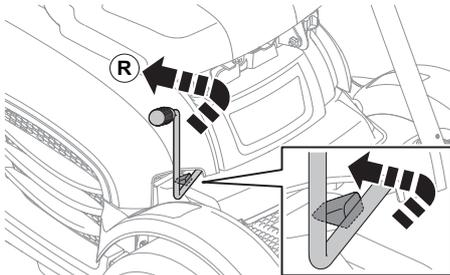
**ACHTUNG!** Ist die Maschine in Bewegung, darf nicht zwischen den Vorwärtsgängen geschaltet werden. Bei jedem Schalten muss der Motor ausgekuppelt werden. Die Maschine vor dem Schalten zwischen Vorwärts- und Rückwärtsgang anhalten, sonst kann ein Getriebeschaden entstehen.
