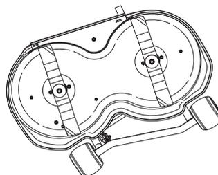
**IMPORTANT!** Une ou plusieurs lames déséquilibrées, suite à une détérioration ou un équilibrage mal effectué après l'affûtage, peuvent provoquer des vibrations dans la machine.
