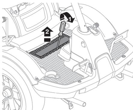
Para volver a colocar la tapa, dóblela primero e introdúzcala en los laterales. Pulse la tapa.
