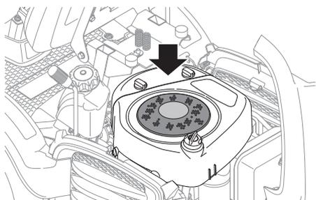
Un intasamento della grata, del condotto o della presa dell'aria refrigerante compromette il raffreddamento del motore con conseguente rischio di danni.
