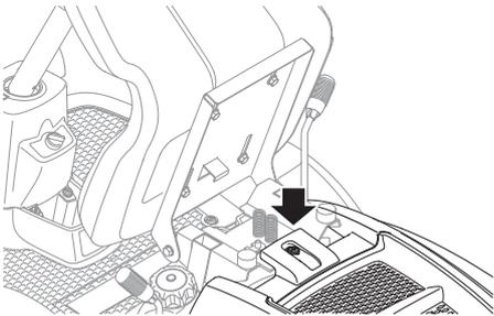
Sicherstellen, dass sich kein Gras, Laub oder Schmutz im Lufteinlass des Motors befindet.
