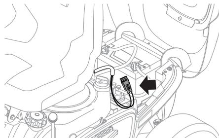
Tipo: Horquilla de clavija plana, 15 A.
