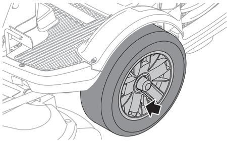
**N.B.!** Een verschillende spanning in de voorbanden brengt met zich mee dat de messen het gras maaien op een verschillende hoogte.
