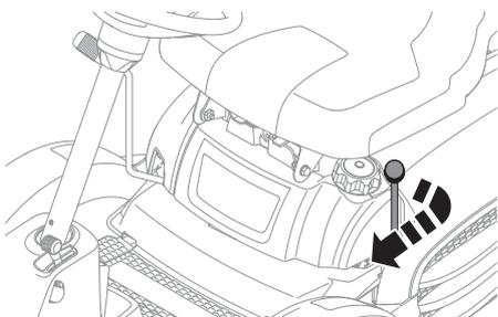
Reculez le levier et bloquez-le de façon à stopper la rotation des lames.
