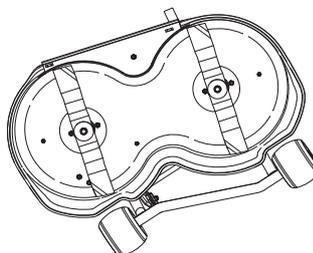
**IMPORTANTE!** Una o più lame sbilanciate, a causa di un danneggiamento o di uno scarso bilanciamento dopo l'affilatura, possono provocare vibrazioni nella macchina.
