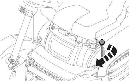
Schieben Sie den Hebel nach hinten und verriegeln Sie ihn, um den Drehbetrieb der Mähmesser zu beenden.
