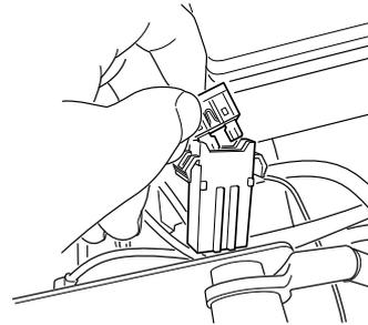
Verwenden Sie beim Ersetzen keinen anderen Sicherungstyp.
