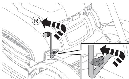
**REMARQUE!** Le passage marche avant-marche arrière ne doit pas être effectué quand la machine est en mouvement.
