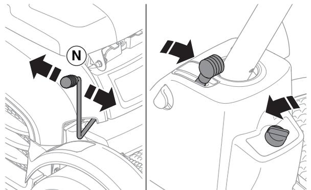
Wenn sich der Aufsitzmäher im Leerlauf befindet, ziehen Sie die Handbremse an.
