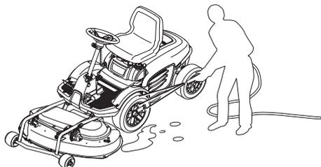
**IMPORTANT!** Garez toujours la machine sur une surface plane, le moteur coupé, avant de procéder à une opération de maintenance.
