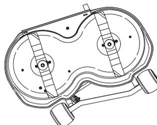
**¡IMPORTANTE!** Si hay una o varias cuchillas desequilibradas por haber sufrido algún daño o por no haberse equilibrado correctamente tras afilarlas, pueden producirse vibraciones en la máquina.
