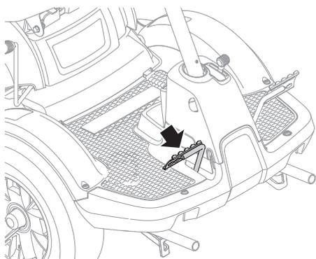
Schakel de koppeling en rem in door het pedaal volledig in te trappen. Het ontkoppelingspedaal koppelt de motor vrij en stopt de aandrijving. De aandrijving van de messen wordt niet beïnvloed door het ontkoppelingspedaal.
