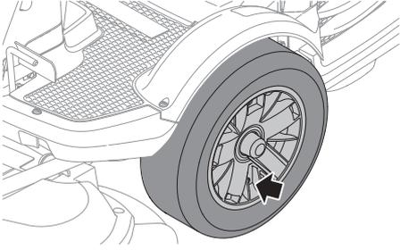
**ACHTUNG!** Unterschiedlicher Luftdruck in den Vorderreifen führt dazu, dass die Messer das Gras nicht gleichmäßig schneiden.
