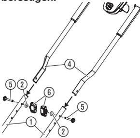
1. Stecken Sie den oberen Griff ④ auf den unteren Griff ①. *Stellen Sie sicher, dass die Griffe vollständig eingesteckt sind und dass die Löcher im Griff ausgerichtet sind.*
