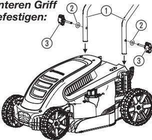
1. Stecken Sie beide unteren Griffe ① in das Produkt. *Stellen Sie sicher, dass die Griffe vollständig eingesteckt sind und dass das Loch im Griff an der Gewindebohrung ausgerichtet ist.*
