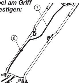
1. Befestigen Sie das Kabel ⑦ mit der Klemme ⑧ am Griff.
