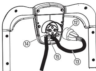
1. Schließen Sie die Buchse ⑫ des Verlängerungskabels ⑬ am Stecker ⑭ an.
