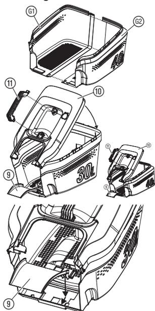
1. **Nur für PowerMax 1400/34:** Verbinden Sie die beiden Teile ⑥①/⑥② des Grasfangkorbs, bis sie hörbar einrasten.
