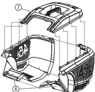
1. Verbinden Sie die beiden Teile ⑥ des Grasfangkorbs, bis die Verbindungen hörbar einrasten.
