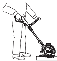
Pozycja robocza 3: Pionowe podkaszanie zwisających krawędzi trawnika
