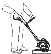
Arbejdsposition 3: Lodret trimning af over- hængende plænekanter
