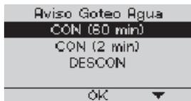
Los parámetros ajustados del aviso goteo de agua tienen un efecto directo en el funcionamiento del programa de pequeñas cantidades. Los aparatos de conexión (p. ej. lavadoras modernas, instalaciones de riego por goteo, etc.) con un consumo reducido de agua se pueden hacer funcionar como sigue:
