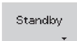
13. La bomba se desconecta automáticamente aprox. 10 segundos después de cerrarse los elementos de cierre. Se ha alcanzado el funcionamiento normal (Standby).
