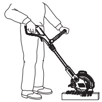
Робоче положення 3: Вертикальна обрізка виступаючих країв трави
