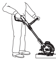
Tööasend 3: Üleulatuvate muruservade vertikaalne trimmimine
