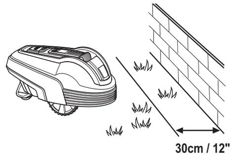
Wenn der Arbeitsbereich an einen kleinen Graben, wie zum Beispiel ein Blumenbeet, oder eine kleine Anhöhe oder eine niedrige Steinkante (3 - 5 cm) grenzt, sollte das Begrenzungskabel in einem Abstand von 20 cm in den Arbeitsbereich hinein verlegt werden. Dadurch wird verhindert, dass die Räder in den Graben oder auf die Steinkante fahren.
