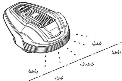
Die **STOP**-Taste oben auf dem Mähroboter dient hauptsächlich dazu, den Mähroboter anzuhalten, wenn er in Betrieb ist. Wenn die **STOP**-Taste gedrückt wird, öffnet sich die Abdeckung, unter der sich das Bedienfeld befindet. Die **STOP**-Taste bleibt eingerastet, bis die Abdeckung wieder geschlossen wird. Dies dient als Startsperr.
