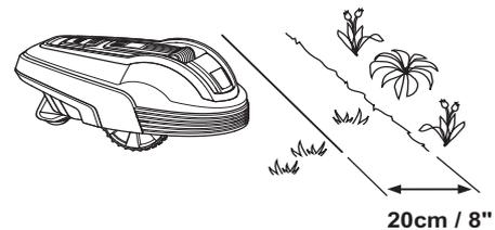
Wenn der Arbeitsbereich an einen Weg mit Steinpflaster oder Ähnlichem grenzt, der sich auf gleicher Ebene wie der Rasen befindet, ist der Mähroboter in der Lage, auch ein wenig über den Weg zu fahren. Das Begrenzungskabel sollte dann 5 cm von der Wegkante entfernt verlegt werden.
