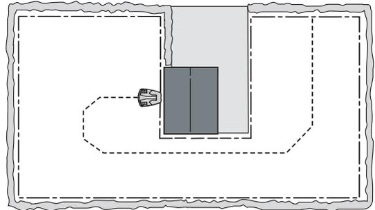
Wenn die Batterie voll geladen ist, verlässt der Mähroboter die Ladestation in einer zufällig gewählten Richtung innerhalb des Ausgangssektors von  $90^\circ$  -  $270^\circ$ .
