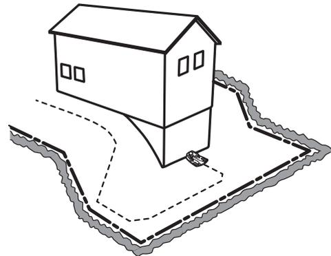
Vermeiden Sie eine Kabelverlegung in engen Winkeln. Dies erschwert es dem Mähroboter, dem Suchkabel zu folgen.
