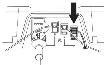
3. Das Kabel mindestens 2 m gerade an der Vorderkante der Platte verlegen.
