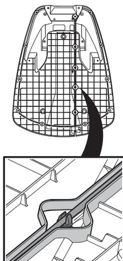
2. Den Verbinder auf dieselbe Weise wie das Begrenzungskabel gemäß den Anweisungen in 3.5 *Anschließen des Begrenzungskabels* oben mit dem Suchkabel verbinden. An den Kontaktstift an der Ladestation anschließen, der mit „Guide“ gekennzeichnet ist.
