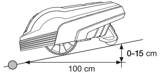
Das Begrenzungskabel sollte nicht quer über einen Abhang mit mehr als 15 % Neigung verlegt werden. Dann besteht das Risiko, dass der Mähroboter Probleme beim Wenden hat. Der Mähroboter hält dann an und zeigt die Fehlermeldung *Außerhalb des Arbeitsbereichs* an. Das entsprechende Risiko wird durch feuchte Witterungsbedingungen erhöht, da die Räder auf nassem Gras wegrutschen können.
