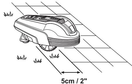
Wenn der Arbeitsbereich durch einen Weg mit Steinpflaster auf gleicher Ebene wie der Rasen getrennt wird, ist der Mähroboter in der Lage, auch ein wenig über den Weg zu fahren. Es kann sogar von Vorteil sein, das Begrenzungskabel unter dem Steinpflaster zu verlegen. Das Begrenzungskabel kann auch zwischen den einzelnen Steinen des Pflasters verlegt werden. Stellen Sie sicher, dass die Fliesen auf der gleichen Höhe mit dem Rasen sind, um übermäßigen Verschleiß des Mähroboters zu verhindern.
