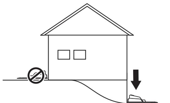
Die Ladestation sollte nicht auf einer Insel aufgestellt werden, da dies das optimale Auslegen des Suchkabels erschwert. Sollte es notwendig sein, die Ladestation auf einer Insel aufzustellen, muss das Suchkabel mit der Insel verbunden werden. Betrachten Sie hierzu die nebenstehende Abbildung. Weiter Informationen finden Sie unter *3.4 Installation des Begrenzungskabels*.
