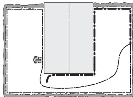
So weitermachen bis ein Teilstück erreicht wird, bei dem die Kabelverbindung nur noch um ein kleines Stück verschoben werden muss, damit das blinkende blaue Licht in ein dauerhaftes grünes Licht wechselt.
