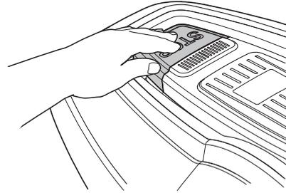
3. Desplace el robot cortacésped por el mango de la parte posterior bajo el robot cortacésped. Desplace el robot cortacésped con el disco de corte lejos del cuerpo.
