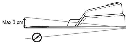
La estación de carga debe estar colocada de modo que pueda doblar su placa base.
