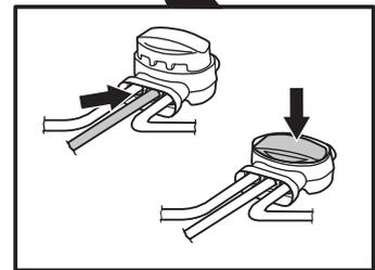
En ese caso, acerque la conexión del cable nuevo al cabo desconectado (más o menos, a la mitad de la sección del cable que podría estar dañada) y vuelva a comprobar si la luz indicadora está en verde o parpadea en amarillo.
