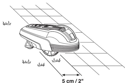
Cuando la zona de trabajo está dividida por un camino de adoquines a la altura del césped, puede permitirse al robot cortacésped pasar por encima. Puede resultar ventajoso colocar el cable perimetral bajo los adoquines. Asegúrese de que las baldosas están a nivel con el césped para evitar un desgaste excesivo del robot cortacésped.
