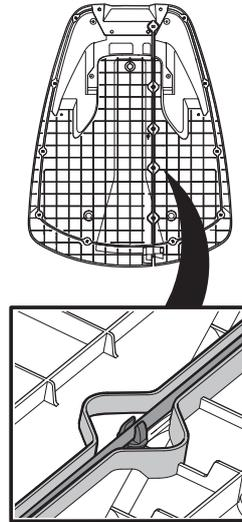
2. Coloque el conector en el cable guía del mismo modo que el cable perimetral, según se indica en 3.5 *Conexión del cable perimetral*. Conéctelo a la clavija pasador de contacto de la estación de carga con la indicación «Guide» (guía).
