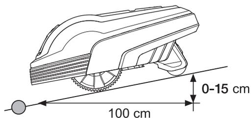
El cable perimetral no debería colocarse a lo largo de una pendiente superior al 15 %. Existe el riesgo de que el robot cortacésped tenga dificultades para dar la vuelta en este punto. El cortacésped se detendrá y aparecerá el mensaje de error *Fuera del área de trabajo*. El riesgo es máximo en condiciones de tiempo húmedo porque las ruedas pueden deslizarse sobre la hierba mojada.
