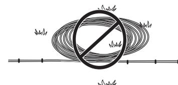
Si el transformador no puede ser conectado directamente a una toma de pared, en ningún caso monte el transformador a una altura a la que exista el riesgo de que se pueda sumergir en el agua (a una distancia mínima de 30 cm del suelo). No se puede colocar el transformador en el suelo.
