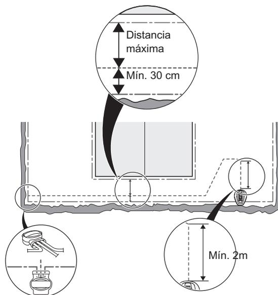
Si es necesario instalar el cable guía en una pendiente acusada, es mejor colocar el cable en diagonal respecto a la pendiente. De este modo, es más fácil que el robot cortacésped siga el cable guía por la pendiente.
