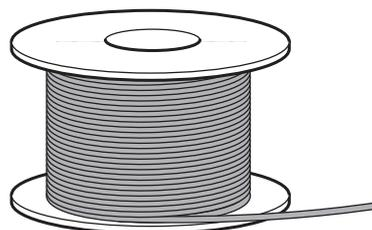
El cable de lazo suministrado para la instalación tiene 200 m de longitud (150 m para el GARDENA R38Li, R40Li, R45Li & R50Li). Si dicha longitud no fuera suficiente, puede adquirir más cable de lazo y acoplarlo al cable de lazo existente utilizando un acoplador original.
