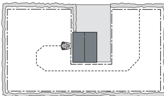
No sitúe la estación de carga en espacios reducidos de la zona de trabajo. Debe haber un cable perimetral de al menos 1,5 metros de longitud extendido hacia la derecha y hacia la izquierda de la estación de carga. El cable se debe colocar recto y hacia el exterior, desde el extremo trasero de la estación de carga. Si se elige cualquier otra ubicación, es posible que el robot cortacésped entre de lado en la estación de carga y tenga dificultades para acoplarse.
