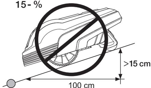
Sin embargo, el cable perimetral puede colocarse por toda la pendiente con una inclinación superior al 15 % si hubiera cualquier obstáculo contra el que el robot cortacésped pueda colisionar, como una valla o un seto espeso.
