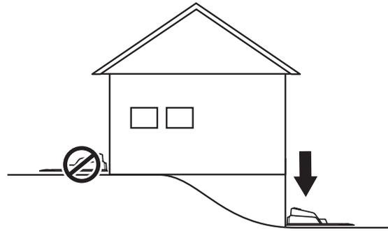
La estación de carga no se debe situar en una isla, dado que esto restringe la colocación óptima del cable guía. Si es necesario instalar la estación de carga en una isla, el cable guía se debe conectar también a la isla. Véase la ilustración contigua. Lea más sobre islas en el capítulo 3.4 *Instalación del cable perimetral*.
