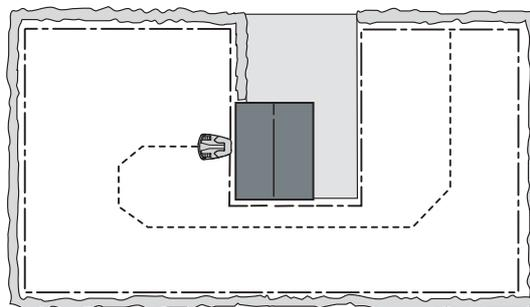
Una vez que la batería está completamente cargada, el robot cortacésped abandona la estación de carga en una dirección seleccionada aleatoriamente dentro del sector de salida de 90 a 270°.
