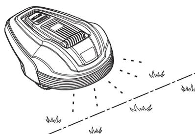
El botón **STOP** situado en la parte superior del robot cortacésped se utiliza principalmente para pararlo. Cuando se pulsa el botón **STOP** se abre una cubierta tras la que se encuentra un panel de control. El botón **STOP** permanece pulsado hasta que se cierra la cubierta de nuevo, actuando así como bloqueo del arranque.
