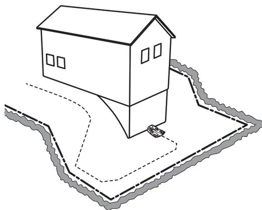
Evite colocar el cable en ángulos cortantes. Esto podría interferir en el robot cortacésped a la hora de seguir el cable guía.
