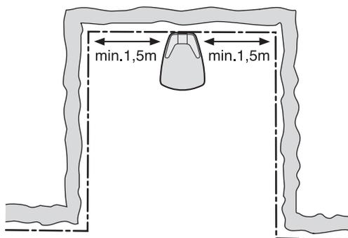
No coloque la estación de carga en una esquina de la zona de trabajo. Debe haber un cable perimetral de al menos 1,5 metros de longitud extendido hacia la derecha y hacia la izquierda de la estación de carga.
