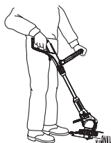
Θέση εργασίας 1: Πρότυπο κόψιμο
