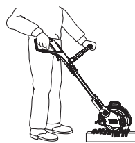
Delovni položaj 3: Navpično košenje previsnih robov travnika
