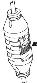
El interruptor de circuito de pérdida a tierra se activará y la máquina se apagará inmediatamente. En caso contrario, póngase en contacto con su distribuidor.
