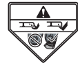
Advertencia! No opere sin el colector o sin la coraza del deflector
