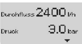
Schließen Sie die Absperrvorrichtungen der Druckleitung, sobald die Pumpe beginnt, kontinuierlich Wasser zu fördern.
