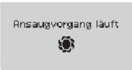
Der Ansaugvorgang kann bis zu 6 min. dauern. Wenn danach kein Wasser gefördert wird, schaltet der Haus- & Gartenautomat ab und im Display wird „**FEHLER 2**“ angezeigt (siehe 7. FEHLERBEHEBUNG).
