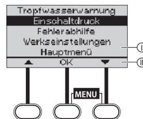
Je nach Anzeige können aktuelle Informationen zum Betriebszustand abgerufen und verschiedene Einstellungen vorgenommen werden. Das Display besteht aus einem Anzeigebereich ① und einer Funktionsleiste ②, welche die jeweilige Funktion der darunterliegenden 3 Tasten angibt, wie z. B.:
