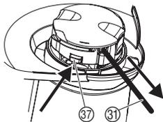
**Eingezogenen / verschweißten Schneidfaden lösen:**
