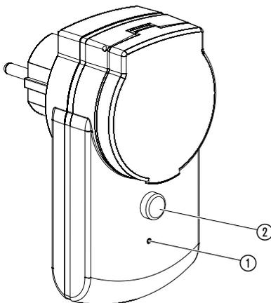
1. Pulse la tecla de encendido/apagado ② para encender manualmente el adaptador (o para apagarlo, si se encuentra encendido).
