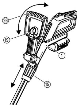
**Ajustar o comprimento do cabo:**
