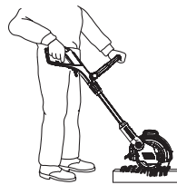
Pracovní poloha 3: Svislé trimování přečnickujících hran trávníku
