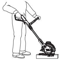
Työasento 3: Ylitse riippuvien nurmikoneurujen pystysuora leikkaus
