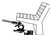
Radni položaj 2: Košenje ispod prepreka
