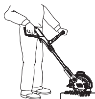
Radni položaj 3: Okomito potkresivanje stršećih rubova travnatih površina
